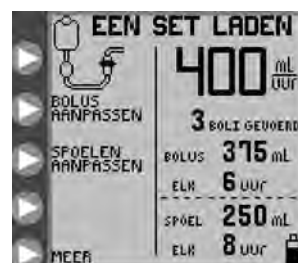
Afbeelding 5B. Scherm van het openingsmenu EEN SET LADEN voor de modus Intermitterende voeding (EZMODE niet ingeschakeld).
