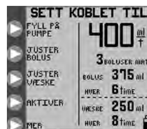
Figur 7D. Startmeny for modus for periodisk ernæring med et ernærings- og skyllesett.
