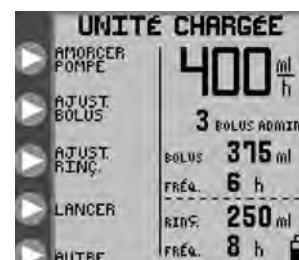
Figure 7D. Menu d'ouverture du mode d'alimentation intermittente avec un set Alimentation et rinçage.
