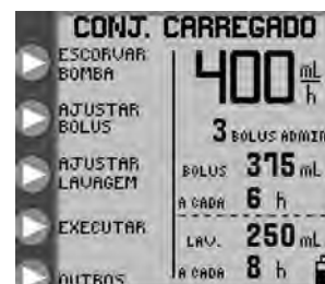
Figura 7D. Menu de abertura para modo de alimentação intermitente com conjuntos de bomba de alimentação e lavagem.
