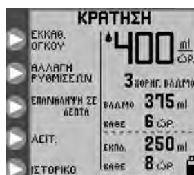
Εικόνα 18Β. Επιλογές λειτουργίας ΚΡΑΤΗΣΗ , λειτουργία διαλείπουσας σίτισης.
