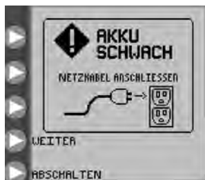
Abbildung 32: Fehlerbildschirm AKKU SCHWACH . Gibt an, dass der Akku sofort aufgeladen werden muss.
