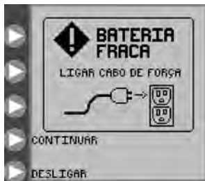
Figura 32. Ecrã de erro de bateria fraca. Indica que a bateria tem de ser imediatamente recarregada.
