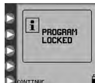
Rysunek 16. Okno Program Locked (zablokowany program), które informuje, że pompa jest w trybie LOCK SETTINGS (zablokowanie ustawień).
