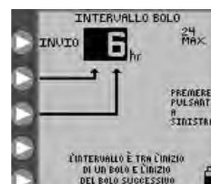
Figura 13E. Impostazione dell'intervallo di tempo che deve intercorrere tra l'inizio di un bolo e il successivo.
