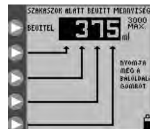
13D ábra: Bolusonkénti térfogat beállítása
