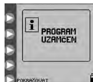
Obrázek 16. Obrazovka PROGRAM UZAMČEN , která znamená, že pampa je v režimu „UZAMČENÍ NASTAVENÍ“
