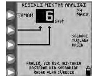
Şekil 13E. Bolus başlangıçları arasındaki zaman aralığını ayarlama.
