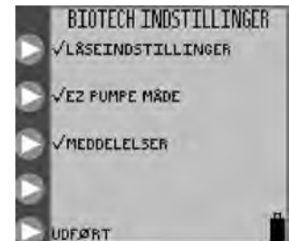
Figur 22. BioTech-skærm med funktionerne Lås indstilling, EZMODE og kommunikation aktiveret.
