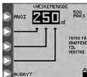
Figur 14B. Stille inn VÆSKEMENNGDE .
