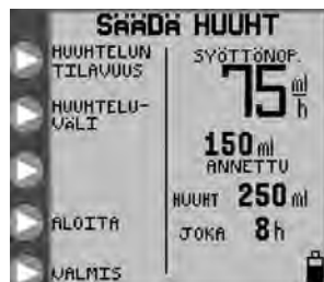
Kuva 12A. SÄÄDÄ HUUHTELU -valikko, jatkuva tila
