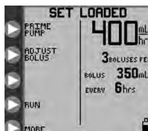
Rysunek 7C. Menu początkowe dla przerywanego trybu żywienia z zestawem samego żywienia.
