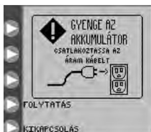
32. ábra "Alacsony akkumulátor töltés" képernyő. Jelzi, hogy az akkumulátort haladéktalanul fel kell tölteni.
