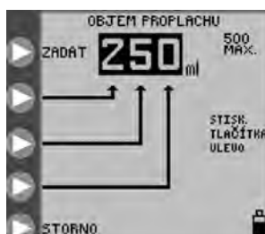
Obrázek 12B. Nastavení objemu proplachování.
