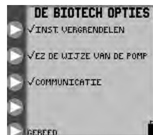
Afbeelding 22. BioTech-optiescherm, met de functies Instellingen vergrendelen, EZMODE (EZ DE WIJZE VAN DE POMP) en Communicatie geactiveerd.
