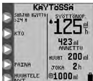
Kuva 34. KÄYTÖSSÄ-näyttö ja pumppu käytössä > 24 tuntia -ilmaisain vasemmassa yläkulmassa
