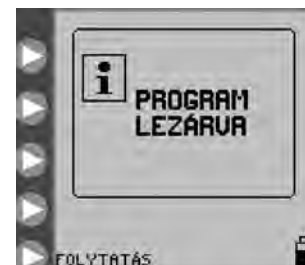
16. ábra "Program Zárva" képernyő, mely jelzi, hogy a pumpa "BEÁLLÍTÁSOK ZÁROLÁSA" üzemmódban van.
