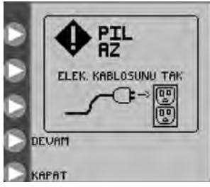
Şekil 32. Düşük Batarya hata ekranı. Bataryanın derhal şarj edilmesi gerektiğini belirtir.
