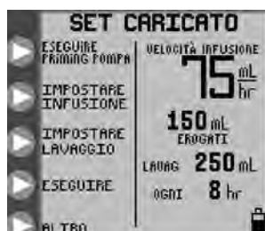
Figura 7B. Menu per la modalità di infusione continua con un set di alimentazione e lavaggio.
