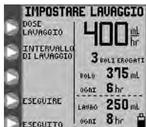
Figura 14A. Menu IMPOSTARE LAVAGGIO , modalità intermittente.
