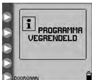
Afbeelding 16. Scherm Programma vergrendeld, wat aangeeft dat de pomp zich in de modus INSTELLINGEN VERGRENDELEN bevindt.
