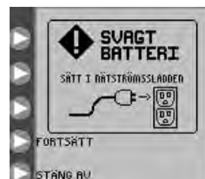
Figur 32. Felskärmen SVAGT BATTERI. Anger att batterierna måste laddas omedelbart.
