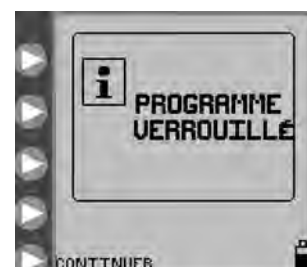
Figure 16. Écran Programme verrouillé, qui indique que la pompe est en mode VERROUILLAGE DES PARAMÈTRES.
