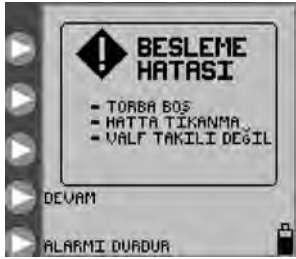
Şekil 28. Besleme Hatası ekranı.
