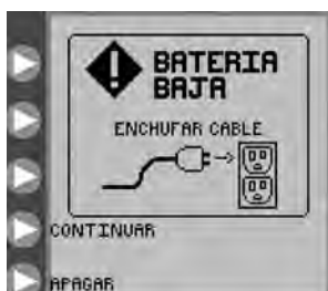
Figura 32. Pantalla de error Batería baja. Indica que es necesario cargar inmediatamente la batería.
