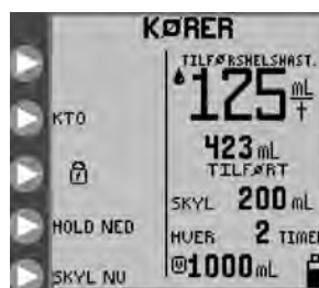
Figur 17. Hængelås angiver, at pumpen er i tilstanden LÅS SKÆRM .
