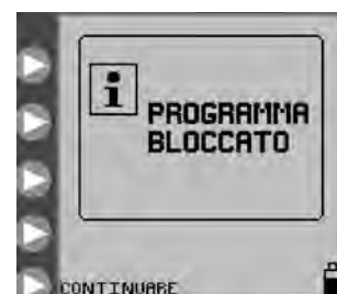
Figura 16. La schermata programma bloccato indica che la pompa è in modalità BLOCCO DELLE IMPOSTAZIONI .
