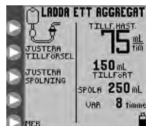
Figur 5A. LADDA ETT AGGREGAT -skärmen med öppningsmeny för kontinuerlig matning (EZ-PROGRAMMET är inte aktiverat).
