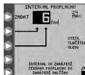
Obrázek 12C. Nastavení časového intervalu proplachování.
