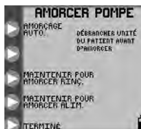
Figure 8B. Menu AMORCER POMPE avec un set Alimentation et rinçage.
