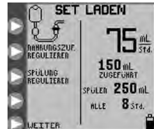
Abbildung 5A: Ausgangsmenü-Bildschirm SET LADEN für die Nahrungszufuhr im Dauerbetrieb (EZMODE nicht aktiviert)
