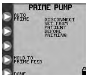
Rysunek 8A. Menu PRIME PUMP (napełnij pompę) dla zestawu samego żywienia.
