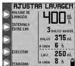
Figura 14A. Menu AJUSTAR LAVAGEM , modo intermitente.
