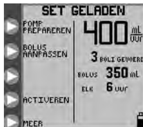
Afbeelding 7C. Openingsmenu voor de modus Intermitterende voeding met een set voor alleen voeding.
