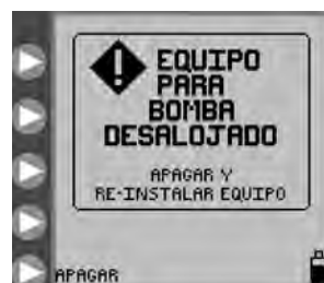
Figura 31. Pantalla de error de equipo para bomba desalojado.
