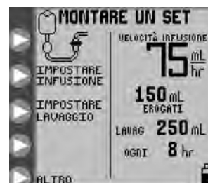
Figura 5A. Schermata del menu MONTARE UN SET per la MODALITÀ di infusione continua (Modalità EZ non attivata).
