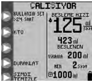
Şekil 34. Ekranın sol üstünde > 24 SAAT Pompa Seti Kullanımı göstergesiyle çalışma ekranı.
