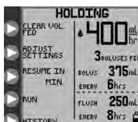
Rysunek 18B. Opcje trybu HOLDING (wstrzymanie), przerywany tryb żywienia.
