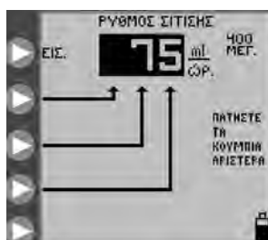
Εικόνα 11B. Ρύθμιση του ρυθμού σίτισης.
