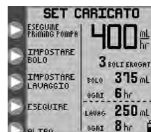
Figura 7D. Menu per la modalità di infusione intermittente con un set di alimentazione e lavaggio.
