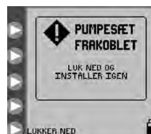
Figur 31. Skærm for fejl ved løsnet pumpesæt.
