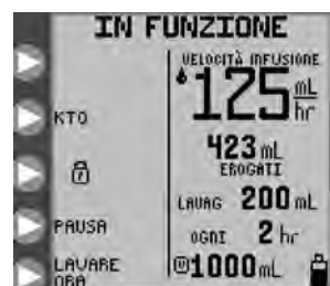
Figura 17. Il lucchetto chiuso indica che la pompa è in modalità BLOCCO DELLO SCHERMO .
