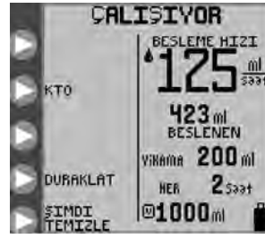
Şekil 15A. Sürekli besleme modu için ÇALIŞMA modu ekranı.
