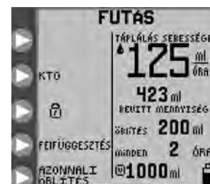
17. ábra A lakat jelzi, hogy a pumpa KÉPERNYŐ ZÁROLÁSA üzemmódban van.
