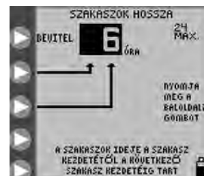
13E ábra: Bolusok indítása közötti időintervallum beállítása
