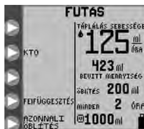
15A ábra: FUTÁS üzemmód képernyője folyamatos tápláláskor.
