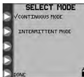
Rysunek 10B. Menu SELECT MODE (wybór trybu) do wyboru trybu ciągłego lub przerywanego.
