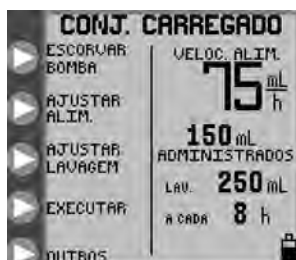
Figura 7B. Menu de abertura para modo de alimentação contínua com conjuntos de bomba de alimentação e exaustamento.
