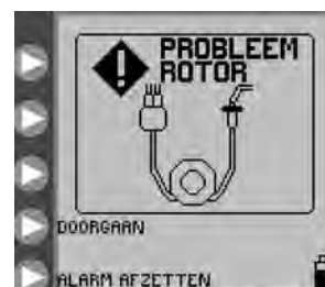
Afbeelding 27. Scherm Probleem rotor. Laad de slang van de set opnieuw en druk op DOORGAAN .
