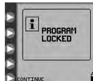
Рисунок 16. Экран «Программа заблокирована», который указывает на то, что насос находится в режиме LOCK SETTINGS (БЛОКИРОВАНИЕ НАСТРОЕК)
