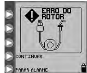
Figura 27. Ecrã do erro de rotor. Reinstale a tubagem do conjunto e pressione CONTINUAR.
