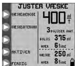
Figur 14A. JUSTER SKYLING -menyen, periodisk modus.
