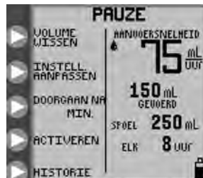
Afbeelding 18A. Opties in de modus PAUZE , modus Continuïteitvoeding.
