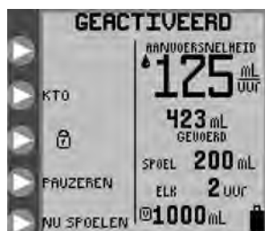
Afbeelding 17. Slot geeft aan dat de pomp zich in de modus SCHERM VERGRENDELEN bevindt.
