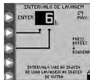
Figura 14C. Definir o intervalo de tempo de lavagem.
