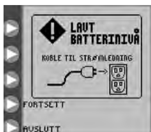
Figur 32. Lavt batterinivå-skjermen. Indikerer at batteriet må lades opp umiddelbart.
