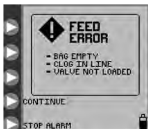
Rysunek 28. Okno błędu żywienia.
