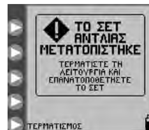
Εικόνα 31. Οθόνη σφάλματος μετατόπισης του σετ αντλίας.
