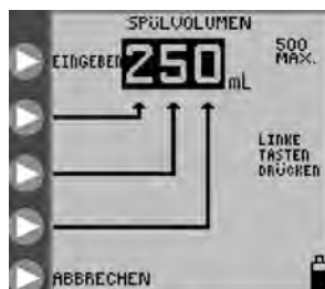
Abbildung 12B: Einstellung des Spülvolumens
