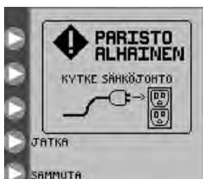
Kuva 32. Paristo alhainen -näyttö osoittaa, että akku on ladattava välittömästi.
