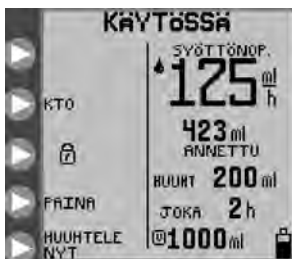
Kuva 17. Lukko osoittaa, että pumppu on NÄYTTÖLUKITUSSA-tilassa.
