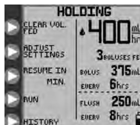
Рисунок 18В. Параметры режима HOLDING (ПАУЗА) , периодический режим подачи питания
