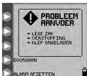
Afbeelding 28. Scherm PROBLEEM AANVOER .
