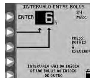
Figura 13E. Definição do tempo de intervalo entre arranques de bolus.
