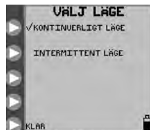
Figur 10B. VÄLJ LÄGE -menyn för val av kontinuerlig eller intermittent matning.
