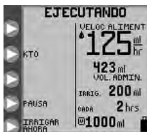
Figura 15A. Pantalla de modo EJECUTANDO para el modo de alimentación continua.
