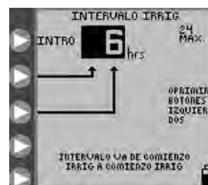
Figura 12C. Selección del intervalo de tiempo de irrigación.
