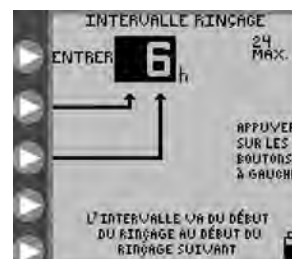
Figure 14C. Réglage de l'intervalle de temps entre les rinçages.
