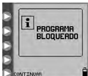
Figura 16. Ecrã Programa bloqueado, o qual indica que a bomba está no modo BLOQUEAR DEFINIÇÕES .
