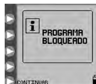
Figura 16. Pantalla Programa bloqueado, que indica que la bomba está en modo BLOQ AJUSTES .
