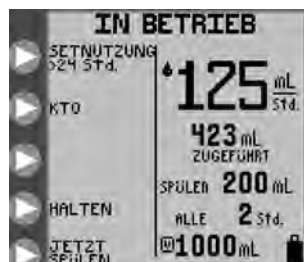
Abbildung 34: Bildschirm „In Betrieb“ mit Anzeige „Setnutzung > 24 Std.“ oben links auf dem Bildschirm
