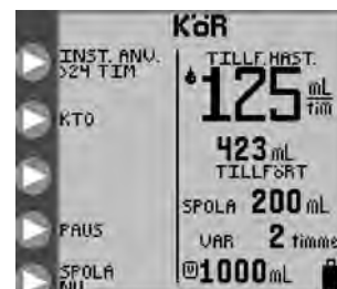
Figur 34. KÖR-skärmen med indikatorn för > 24 timmars användning av pumpsetet längst upp till vänster på skärmen.
