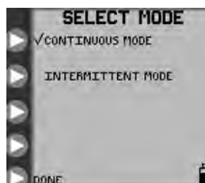
Рисунок 10B. Меню SELECT MODE (ВЫБОР РЕЖИМА) для выбора непрерывного или периодического режима подачи
