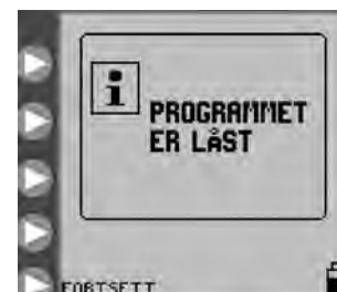
Figur 16. Skjermen Program låst, som indikerer at pumpen er i modusen LÅS INNSTILLINGER .
