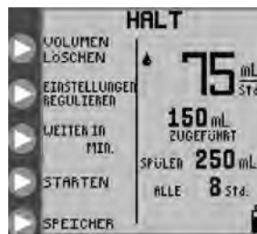
Abbildung 18A: Optionen im Zustand HALT bei Nahrungszufuhr im Dauerbetrieb
