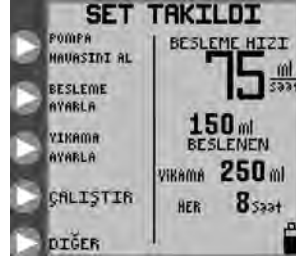
Şekil 7B. Besleme & Yıkama setiyle Sürekli Besleme modu için açılış menüsü.
