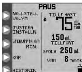
Figur 18A. Läget PAUS alternativ, kontinuerligt matningsläge.
