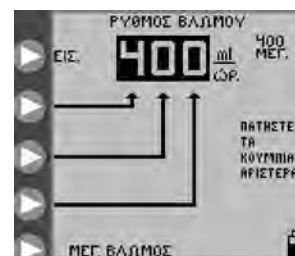
Εικόνα 13B. Ρύθμιση του ρυθμού bolus.
