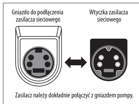
Rysunek 2. Ustawienie wtyczki zasilacza sieciowego względem gniazda wejściowego.
