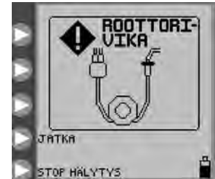
Kuva 27. Roottorivirheen näyttö ASENNA SARJA letkut uudelleen ja paina JATKA.
