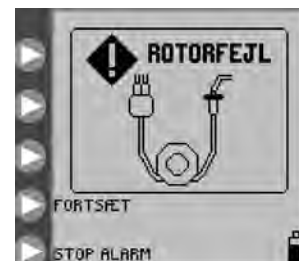
Figur 27. Skærm for rotorfejl. Sæt slangen på igen, og tryk på FORTSÆT.
