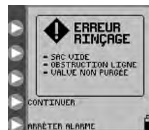
Figure 29. Écran Erreur de rinçage.
