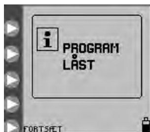
Figur 16. Skærm for program låst, der angiver, at pumpen er i tilstanden LÅS INDSTILLINGER .
