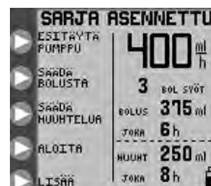
Kuva 7D. Avausvalikko, jaksottainen ruokintatila, ruokinta- ja huuhtelutarja
